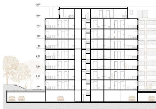
Blok A - vzdolžni prerez | 1 : 200
